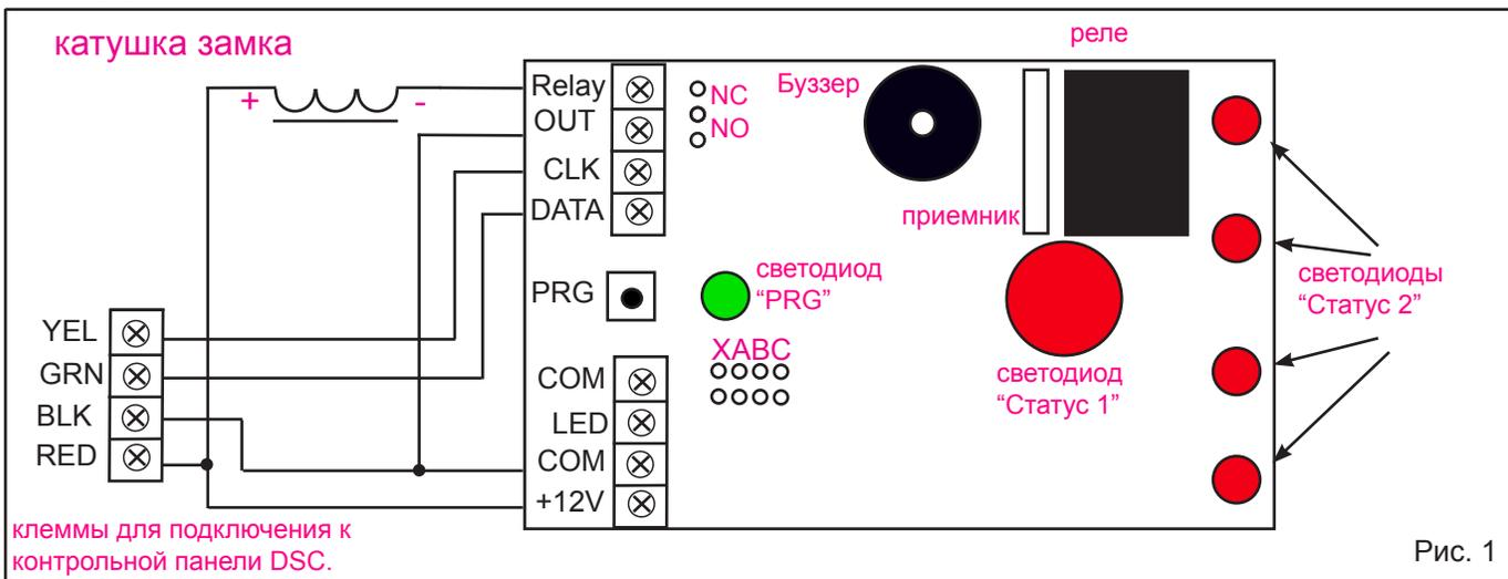
Снимите верхнюю белую крышку NV PB 28. Соедините клеммы "+12V", "COM", "CLK", "DATA" на плате PB 28 с клеммами "RED", "BLK", "YEL", "GRN" на плате контрольной панели соответственно. (см. рис.1). Подключите электромагнитный замок - черный провод соедините с клеммой "RELAY", красный - с клеммой "+12V", вторую клемму "RELAY" соедините с клеммой "COM". Закрепите NV PB 28 на несущей поверхности при помощи двух винтов-саморезов через сквозные отверстия находящиеся на крышке корпуса.
